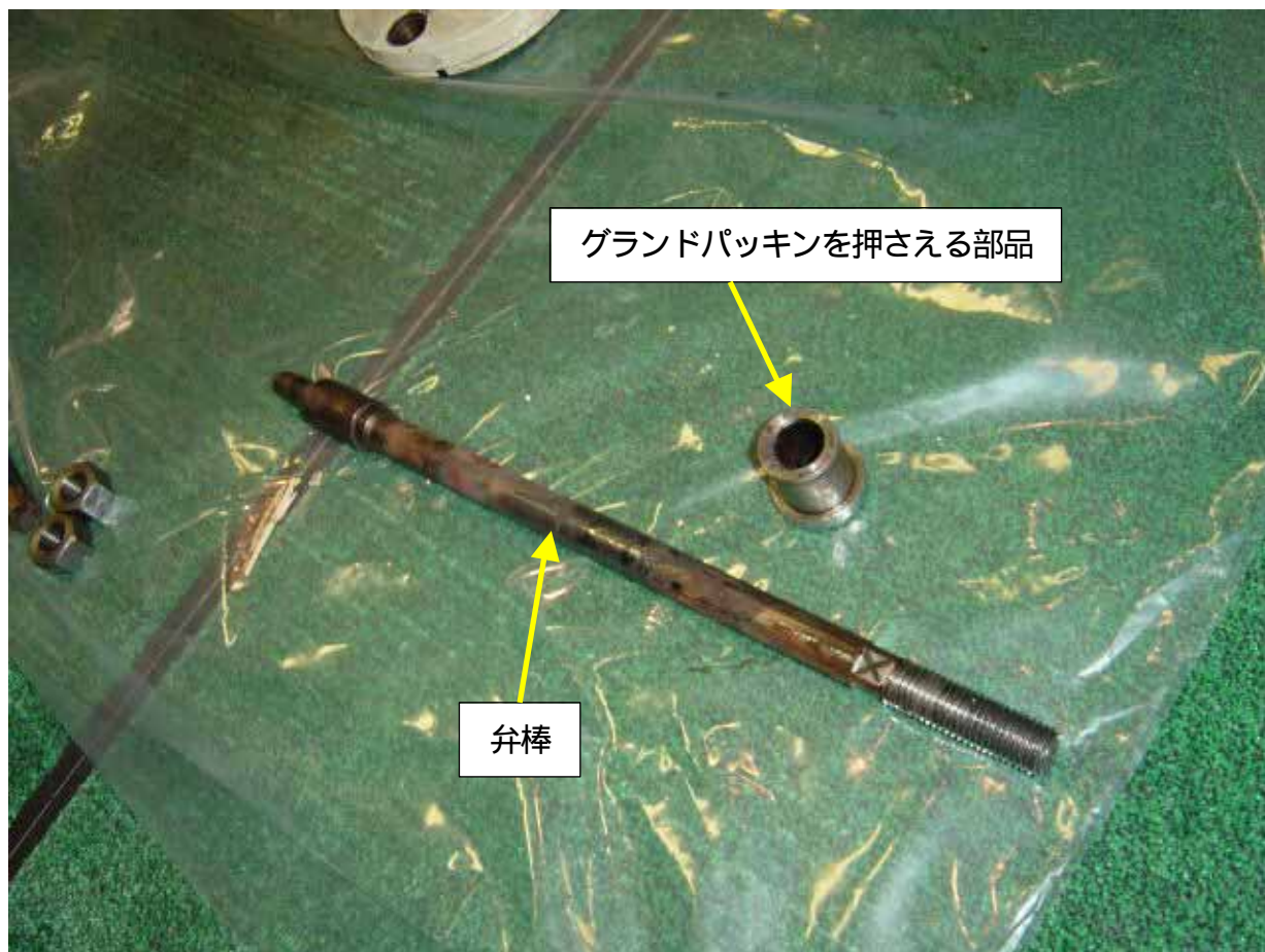
弁棒及びグランドパッキンを押さえる部品単体
