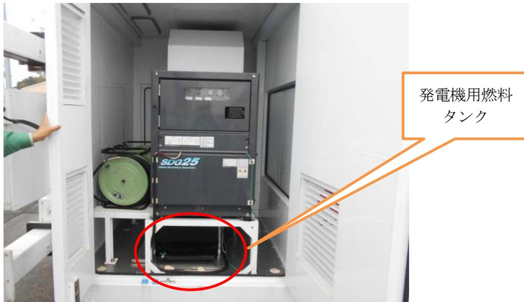
発電機用燃料タンク取付状態 (発電機室内背面)
