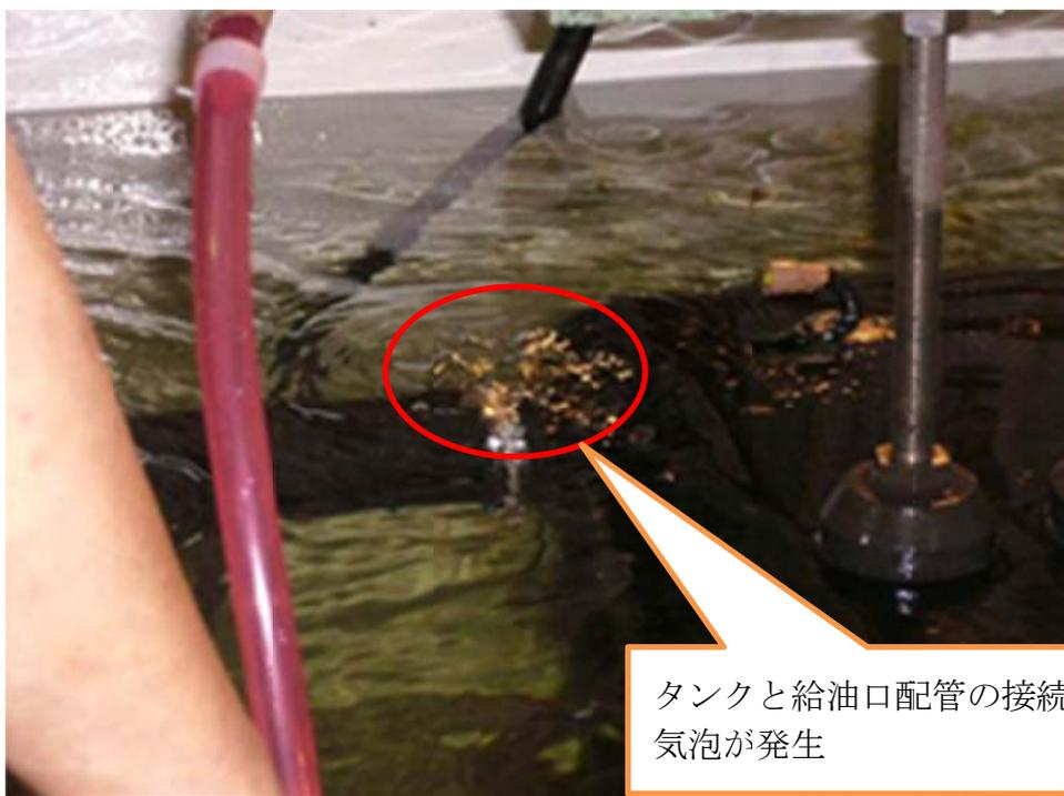
発電機用燃料タンクの漏えい確認試験結果
