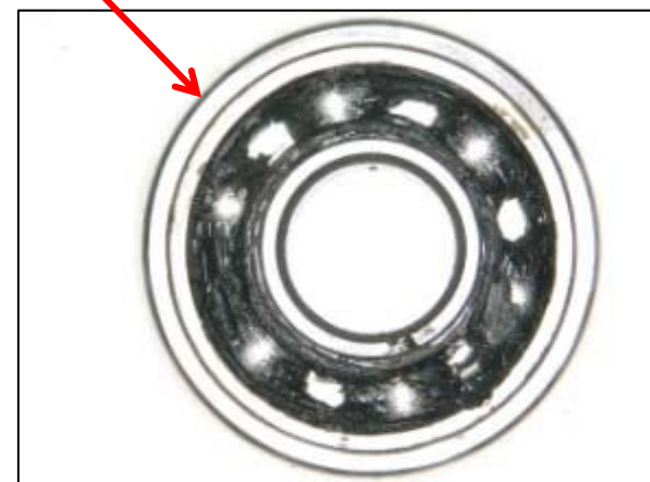
(モータ上部側の軸受けのグリスの状態)
