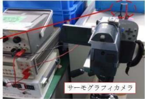
ヒューズ温度変化調査 試験状況
