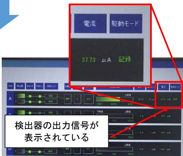
改修後の炉内核計装装置の表示画面
