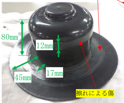
熱影響による損傷と接着痕
