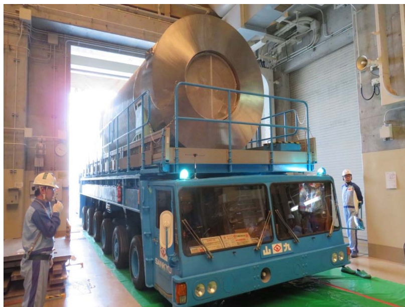
写真1 使用済燃料構内輸送の状況
